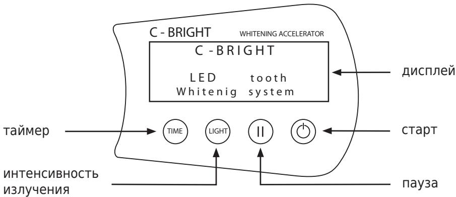
2. С помощью кнопки «TIME» настройте таймер: 10сек, 30сек, 1 мин, 2 мин, 5 мин, 8 мин, 10 мин, 15 мин, 20 мин, 30 мин.
