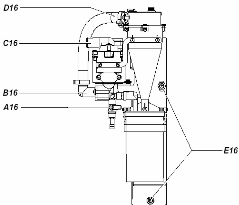
A16 = СЛИВНОЙ КРАН ГИДРОЦИКЛОНА
