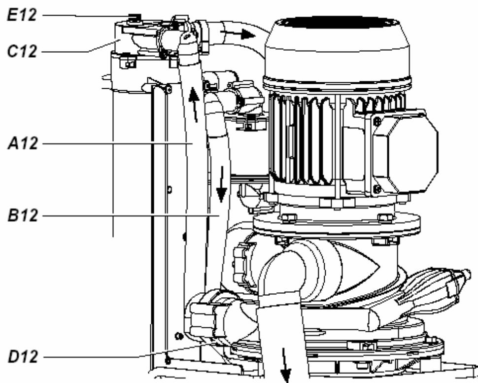
A12 = ТРУБА ПОД ДАВЛЕНИЕМ НА ВХОДЕ ГИДРОЦИКЛОНА
