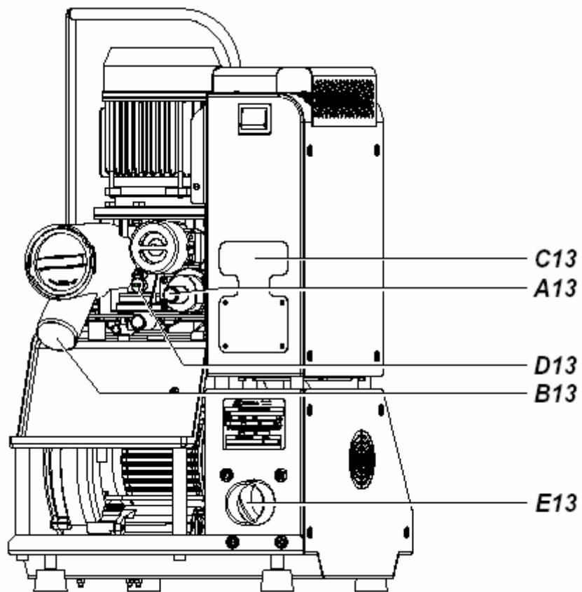
A13 = КАНАЛ ОТВОДА ЖИДКОСТИ ИЗ ЦЕНТРИФУГИ
