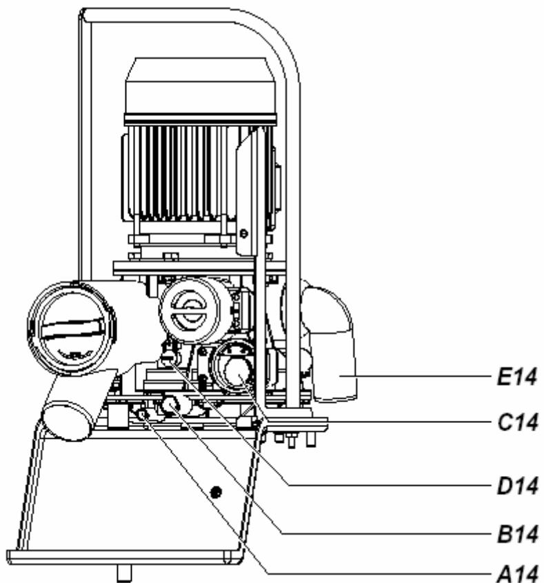
A14 = РУЧНОЙ СЛИВ ИЗ КОРПУСА ГИДРОЦИКЛОНА И ЦЕНТРИФУГИ-СЕПАРАТОРА
