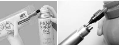
Смазка производится любым многофункциональным смазочным спреем для стоматологических наконечников.
