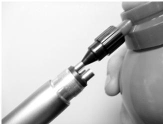
Смазка производится любым многофункциональным смазочным спреем для стоматологических наконечников.
