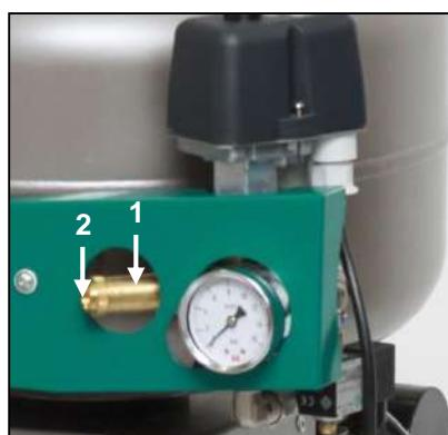
**!** Никогда не используйте предохранительный клапан для сброса давления в ресивере. Это может повредить предохранительный клапан. Максимально допустимое давление для клапана настроено производителем. Регулировка запрещена!
