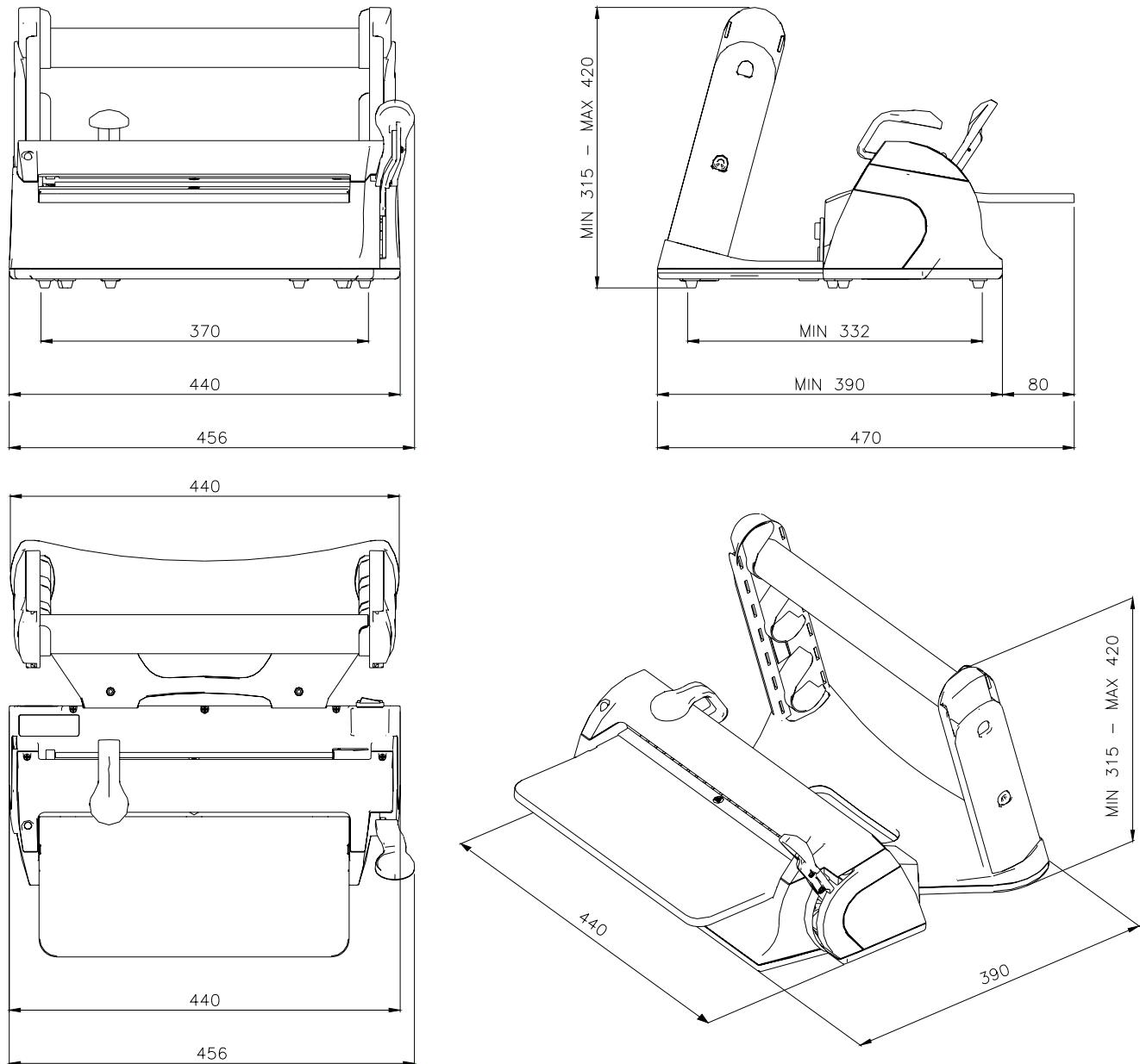
Габаритные размеры запечатывающего устройства
