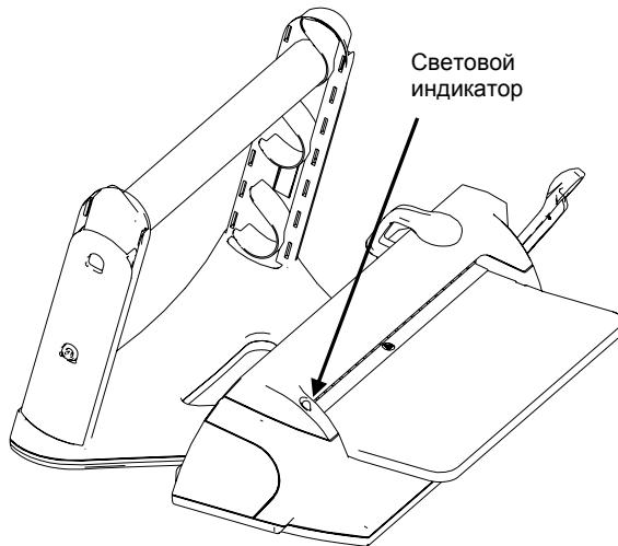
**ПРИМЕЧАНИЕ:** если во время нагрева (мигающий оранжевый индикатор) опускается рычаг запечатывания, индикатор становится красным, горящим постоянно, и оборудование начинает периодически издавать звук, означающий то, что оно еще не готово к работе. Поднять вновь рычаг и подождать до тех пор, пока индикатор не загорится ровным зеленым светом.
