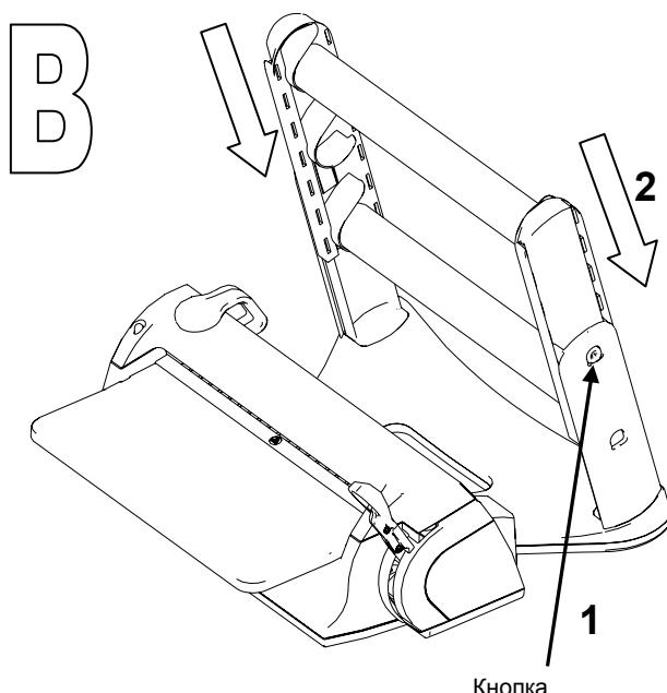
Когда рулонодержатель поднят, для его опускания:
