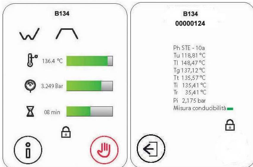
На следующем экране указываются постоянно меняющиеся данные о текущей фазе стерилизации (её название – в верхней строке). Серийный номер устройства, количество выполненных циклов и дата установки показаны внизу, над строкой с данными о прошивке. Кнопка «стрелка назад» возвращает пользователя на предыдущий экран; она находится в нижней части.
