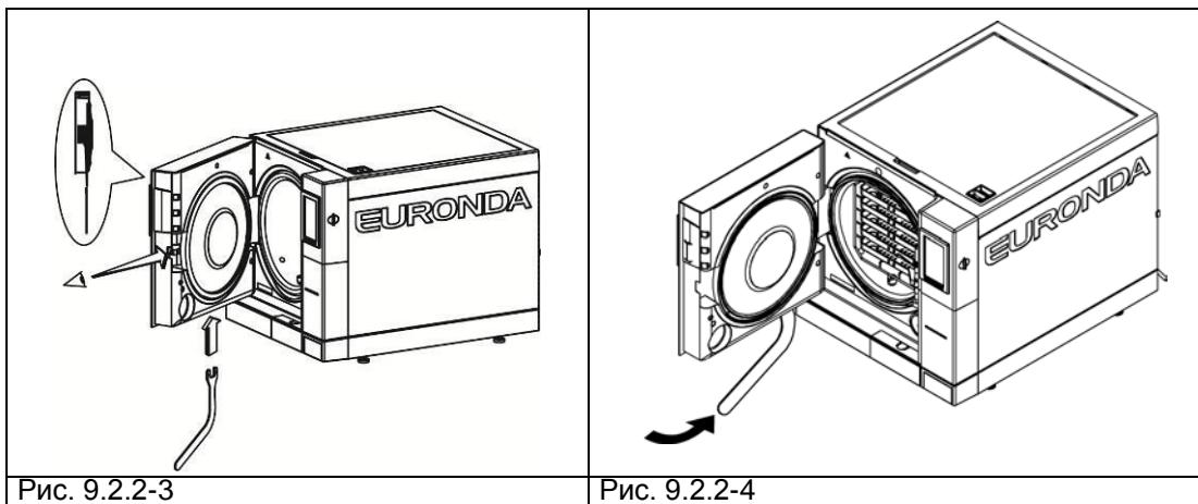
4. Поверните настроечную шпильку против часовой стрелки, наблюдая за дверцей, на 1/4 оборота (для закрывания) (Рис. 9.2.2-4).
