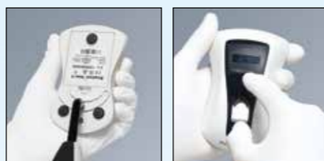
Диаметр круглого световода измеряется при помощи датчика на задней поверхности радиометра.
