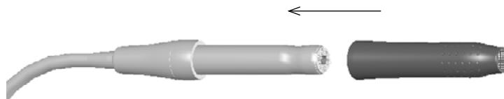
6. Закрутите насадку для полировки по часовой стрелке в наконечник с усилием до остановки.
