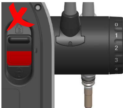
Шнур наконечника не полностью подключен.
