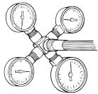
Для работы SONICflex требуется развивающее давление не менее 2,5 бар (36 psi). Более высокое развивающее давление автоматически уменьшается внутри SONICflex. Расход воздуха составляет ок. 20 - 40 Нл/мин. Контрольный манометр (Арт. № 0.411.8731) вставить между переходником MULTIflex и SONICflex.
