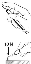
Может случиться, что вследствие длительной нагрузки или повреждения (падения на пол или механического изменения первоначальной формы) произойдет разрушение. Поэтому перед каждым использованием легким нажатием большим или указательным пальцем проверять эксплуатационную надежность и безопасность насадки.
