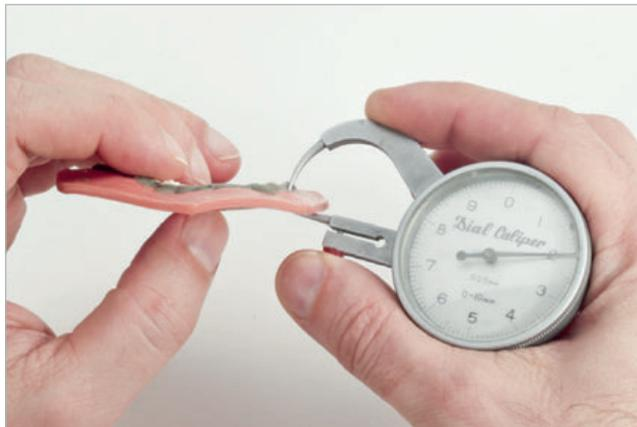
2.01 Измерить толщину по центру при помощи толщиномера. Самая толстая часть обычно располагается в области премоляра.
