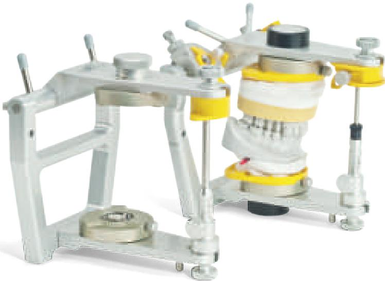
Описанная в данном руководстве установка модели выполнялась с использованием лабораторного инструмента для установки гипсовых моделей, однако такая операция легко осуществима и на всех остальных артикуляторах SAM.
