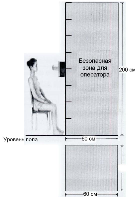
Рис. Границы безопасной зоны для оператора
