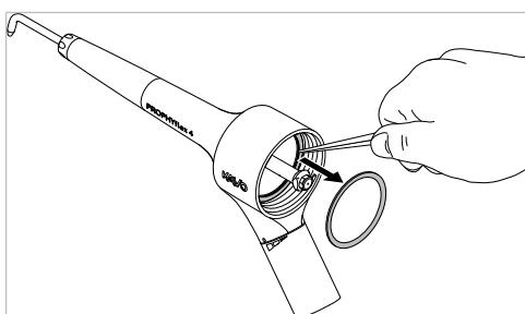
6 Устранение неисправностей | 6.3 Замена уплотнительного кольца на емкости для порошка
