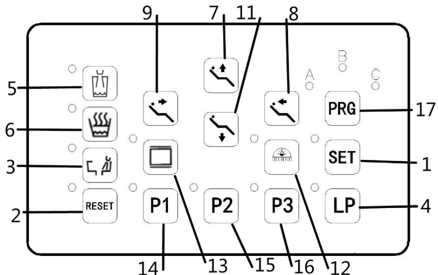
Данная стоматологическая установка оснащена многооперационной системой координации и регулирования. На панели управления находится 17 клавиш.
