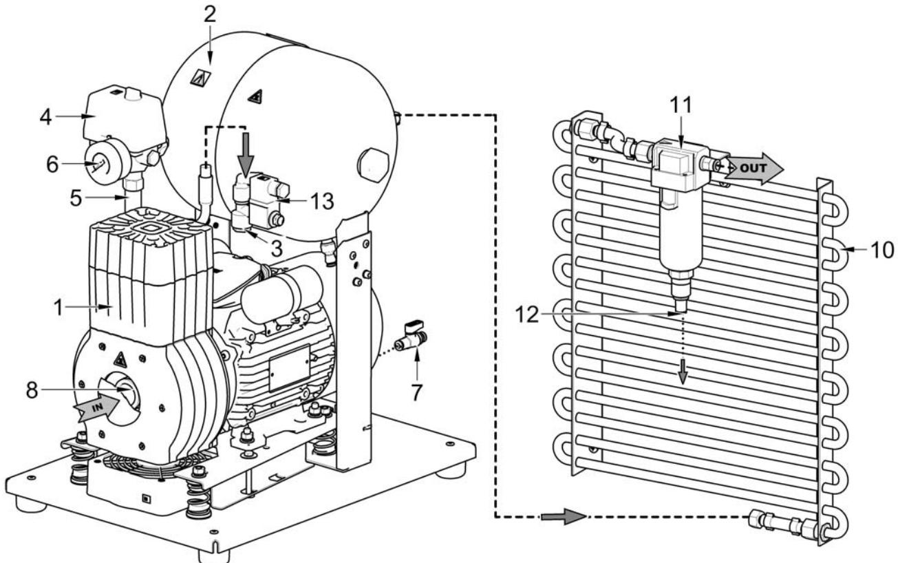
Рис. 3. DK50-10 Z/M (компрессор с осушителем)
