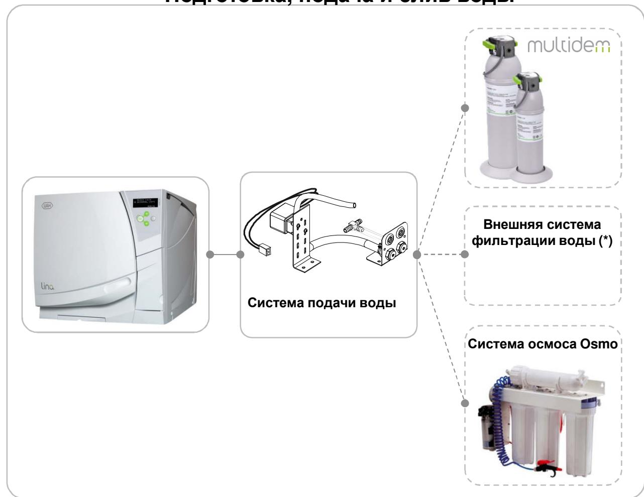
(\*) Система фильтрации воды должна быть оснащена устройством предотвращения противотока в соответствии с требованиями стандарта IEC 61770 и также в соответствии с местными и национальными требованиями. Максимальное давление составляет 8,6 бар, минимальный расход – 2,5 л/мин
