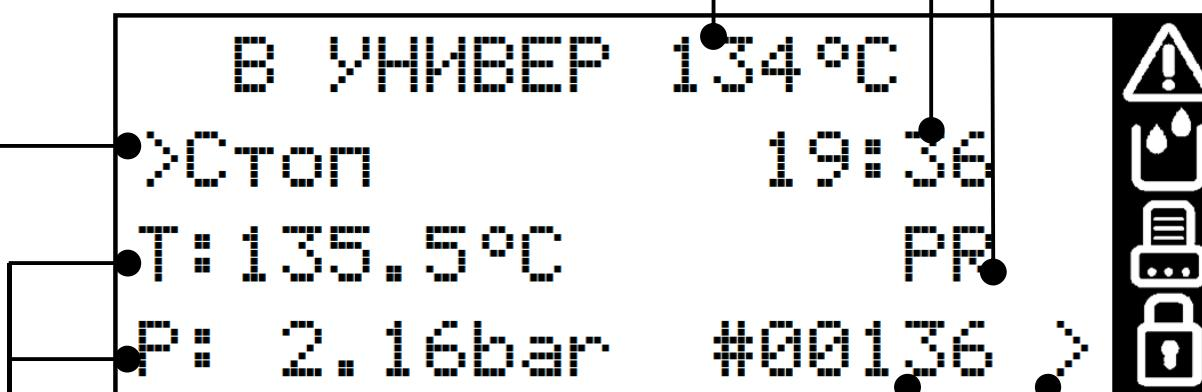
**Текущие давление и температура** камеры стерилизатора
