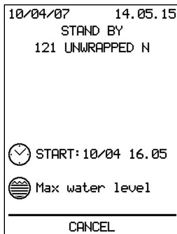
При настройке часа, стерилизатор автоматически включает выбранный цикл.
