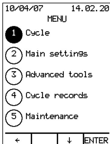
С помощью стрелок ↓ можно перемещаться по списку, выделять требуемое наименование и нажатием на ВВОД обеспечивается доступ к выбранному меню.
