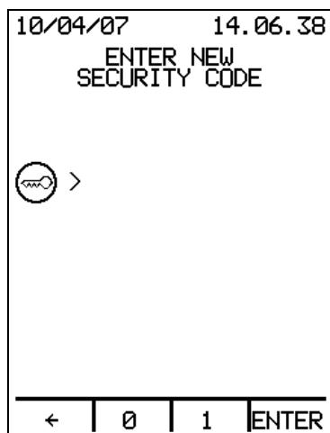
Нажатием на клавишу ← стирается последняя введенная цифра или, если на дисплее отсутствуют цифры, обеспечивается возврат назад без изменения кода.
