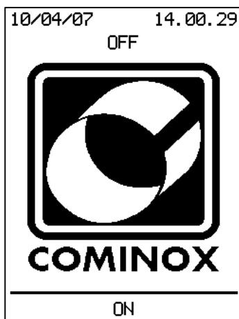
Нажать на ВКЛ. (ON) с помощью одной из четырех мультифункциональных клавиш, находящихся под дисплеем, на экране визуализируется сообщение Добро пожаловать и затем стерилизатор устанавливается в состояние РЕЖИМ ОЖИДАНИЯ (STAND BY).
