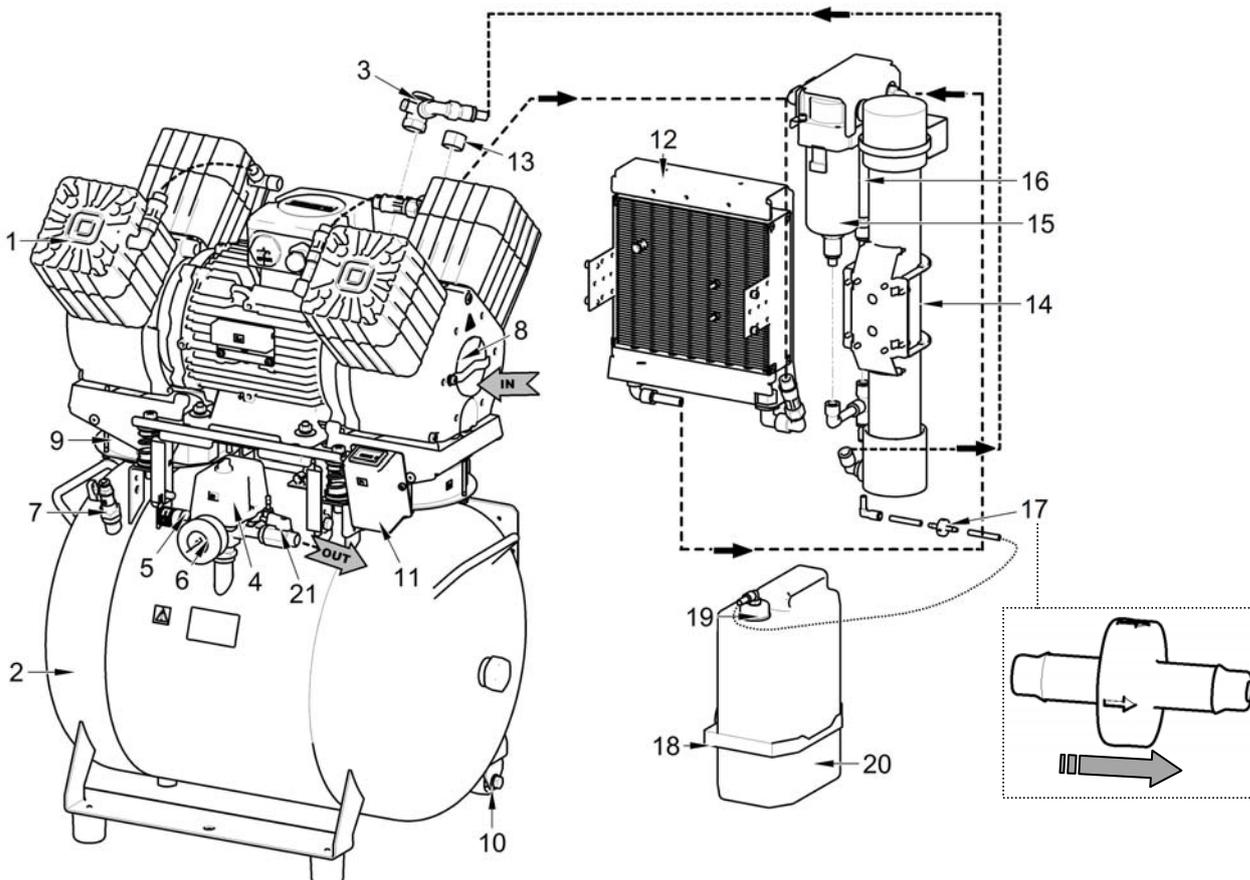
Рис. 4. Компрессор с адсорбционным осушителем (NDM)
