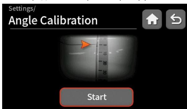
Если оборудование движется, калибровка останавливается с появлением следующего экрана. Перед нажатием кнопки [Start] убедитесь, что оборудование полностью остановлено.
