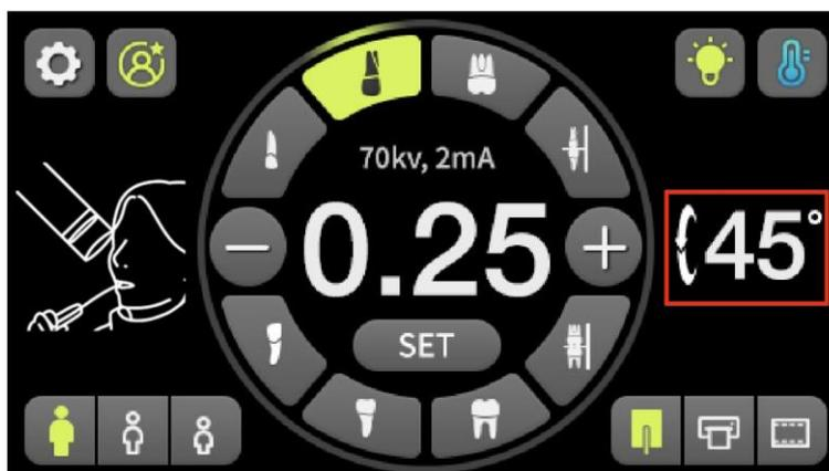
2. Значок задней части зуба, который система может оптимально захватить, мигает под настроенным углом.
