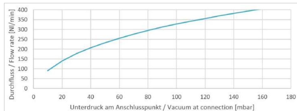
Падение давления в точке подключения для аспирационного устройства полусухого и мокрого типа
