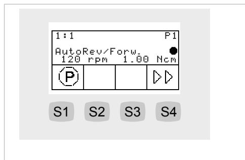
В меню ENDO отображается статус эндодонтического микромотора:
