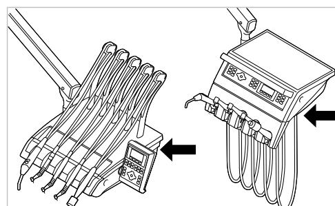
Место расположения заводской таблички и маркировка рабочих частей типа BF на модуле врача
