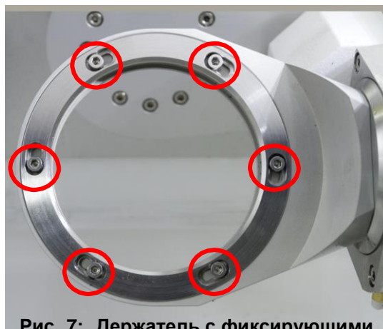
Рис 7: Держатель с фиксирующими винтами.
