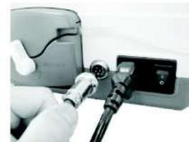
Пожалуйста, вставьте разъем ножной педали. Проверьте совпадения контактов соединения разъема педали с разъемом блока управления. После чего заверните фиксирующее кольцо до упора.
