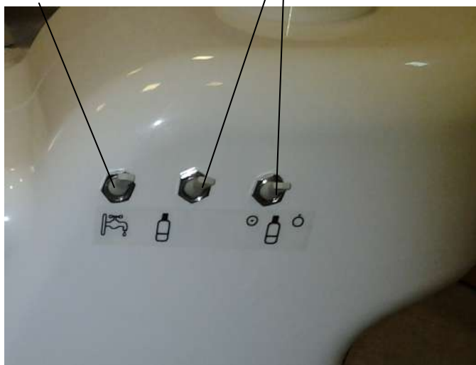
Рис. 7.6. Система автономной подачи воды
