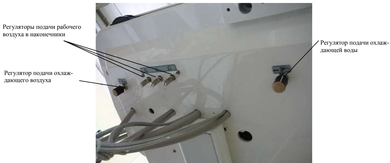
Рис. 7.5. Регуляторы давления воды и воздуха
