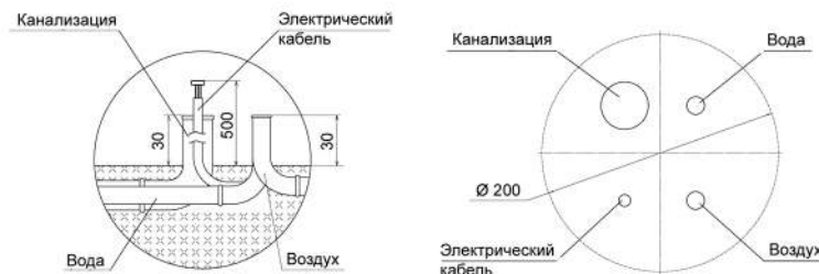
Рис. 8.4. Примерная схема подвода магистралей
