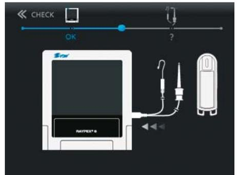
Рис. 32. Подключение измерительного кабеля
