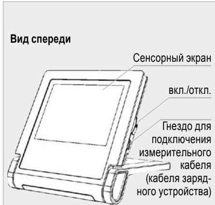
Рис. 4. Прибор RAYPEX® 6, вид спереди
