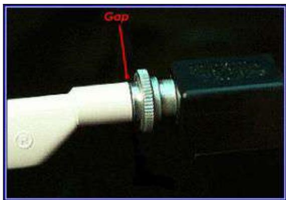
На рис. 61 показано неправильное (неплотное) подсоединение кодирующего устройства к ручке (обратите внимание на зазор между ручкой и кодирующим устройством). Используйте нарезную головку, чтобы плотно закрутить кодирующее устройство в зонд. Вы не должны видеть зазор.
