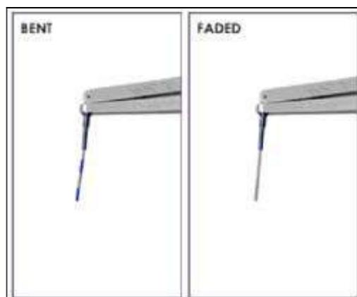
**Рис. 62 Пример погнутой насадки и насадки со стертой разметкой**
