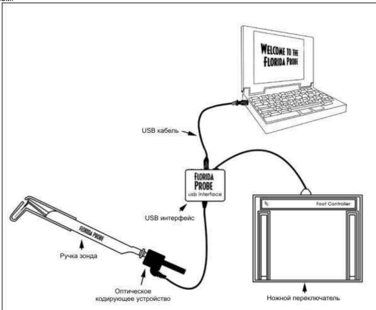
Рис. 2 Инсталляция технического оборудования «Florida Probe»
