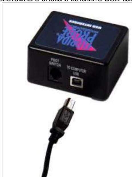
Рис. 4 Подключение USB-кабеля к интерфейсу
