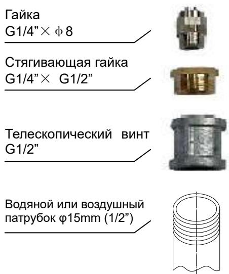
**Рис. 5-1 Описание сборки соединительного патрубка.**
