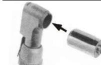
Вставьте новый картридж в головку наконечника, которая должна быть немного приподнята, чтобы деталь совпала с желобом внутри передней части головки, для обеспечения правильного крепления.
