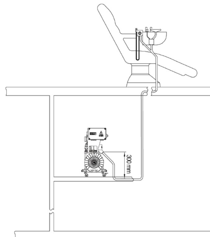
Рис. В. Установка аспиратора ниже уровня стоматологической установки
